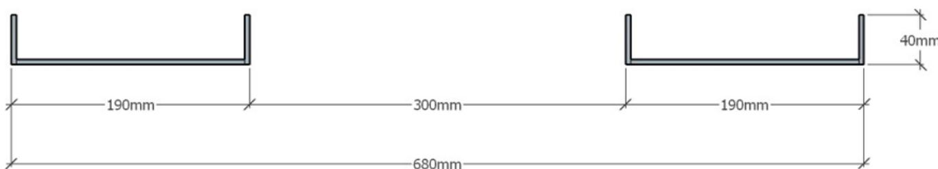
4. Положите перекладины-уголки под швеллеры максимально близко к кромке ступеней, чтобы они не мешали подъёму и спуску по маршу. Наметьте точки для сверления отверстий под заклёпки.
